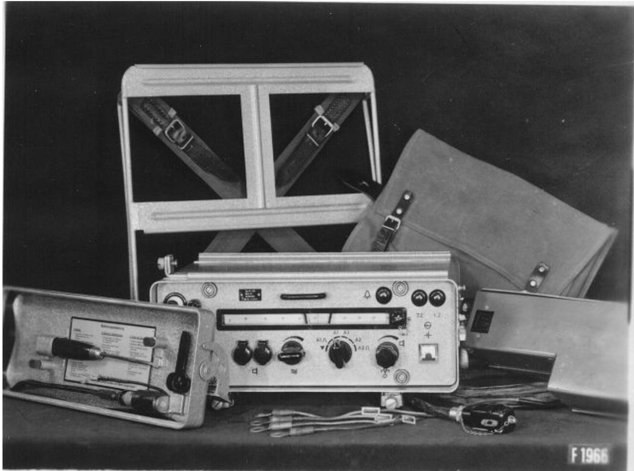
Zubehör bestehend aus Stabantenne im Deckel, Tragegestell mit Klappfüßen für Schrägstellung auf einem Tisch, Zubehörtasche für Langdrahtantenne, Kopfhörer und Batteriekasten.
